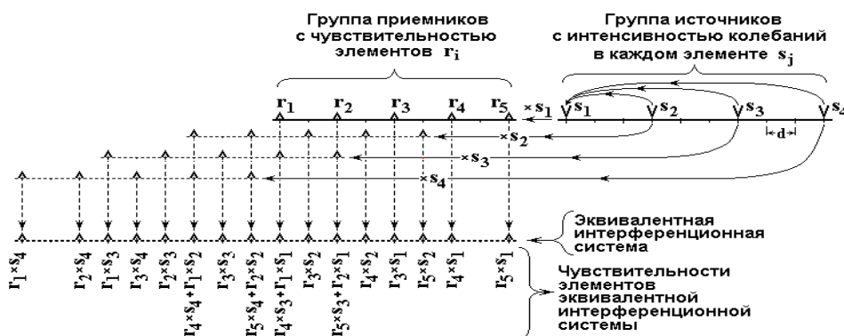
Рисунок 2 - Сложная интерференционная система. Формирование эквивалентной интерференционной системы
