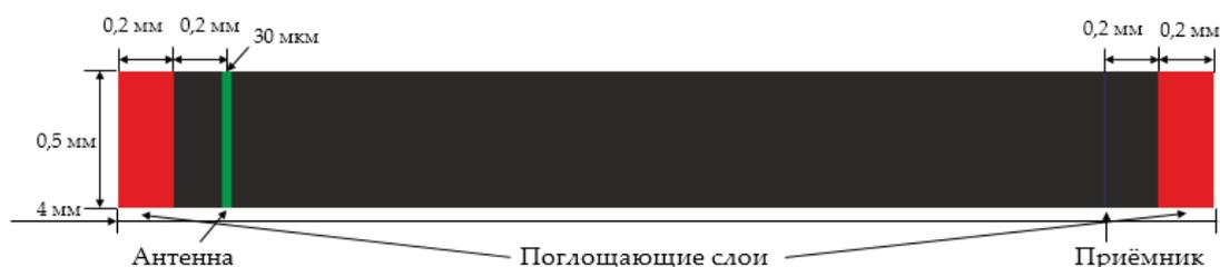
Рисунок 4 – Схема волновода.
