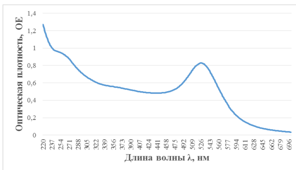
Рисунок 2 - Спектр поглощения препарата золотых наночастиц с размером 15 нм.
