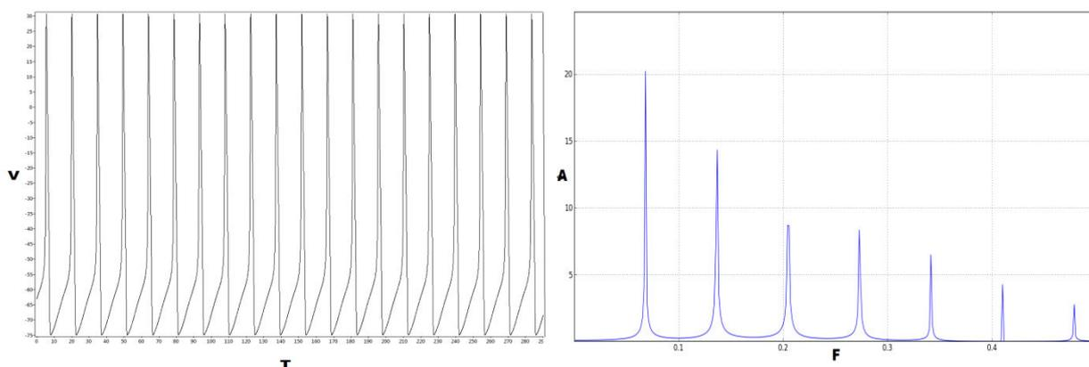
Рис.1. Временной ряд и амплитудный спектр сигнала нелинейного осциллятора на основании модели Ходжкина – Хаксли с данными параметрами.
