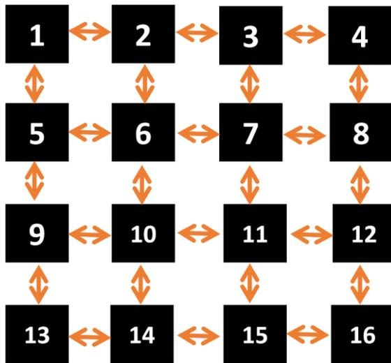
Рис.5. Схема ансамбля нелинейных осцилляторов с архитектурой связи типа «Решетка».
