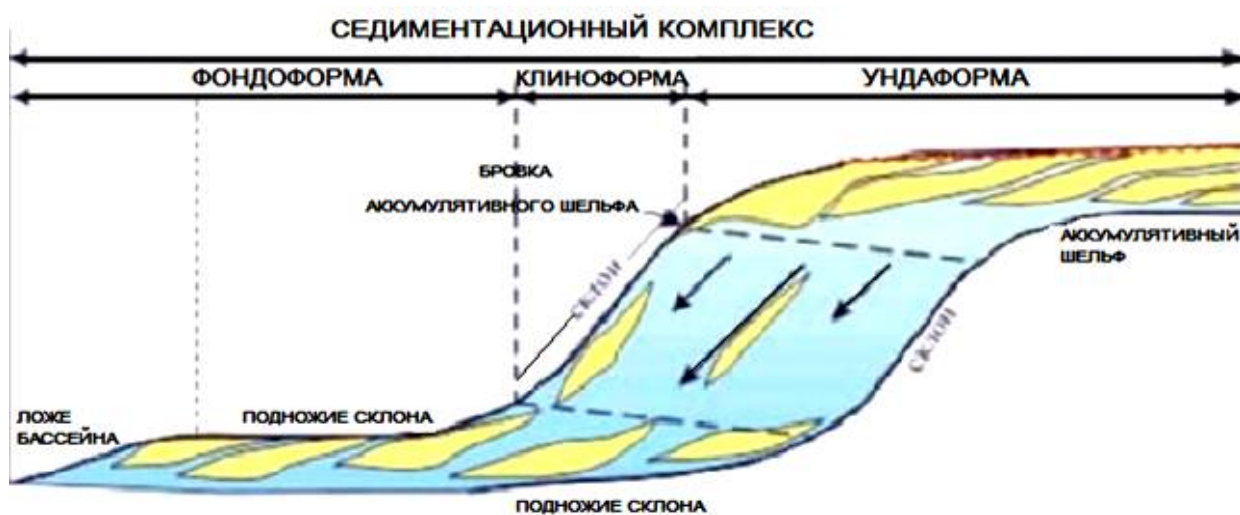
Рисунок 1 – Косослоистая модель строения шельфовых пластов клиноформного комплекса (Ухлова Г.Д., Варламов С.Н.).
