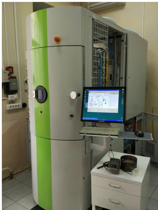
Рисунок 3 – Вакуумная система для напыления тонких пленок
