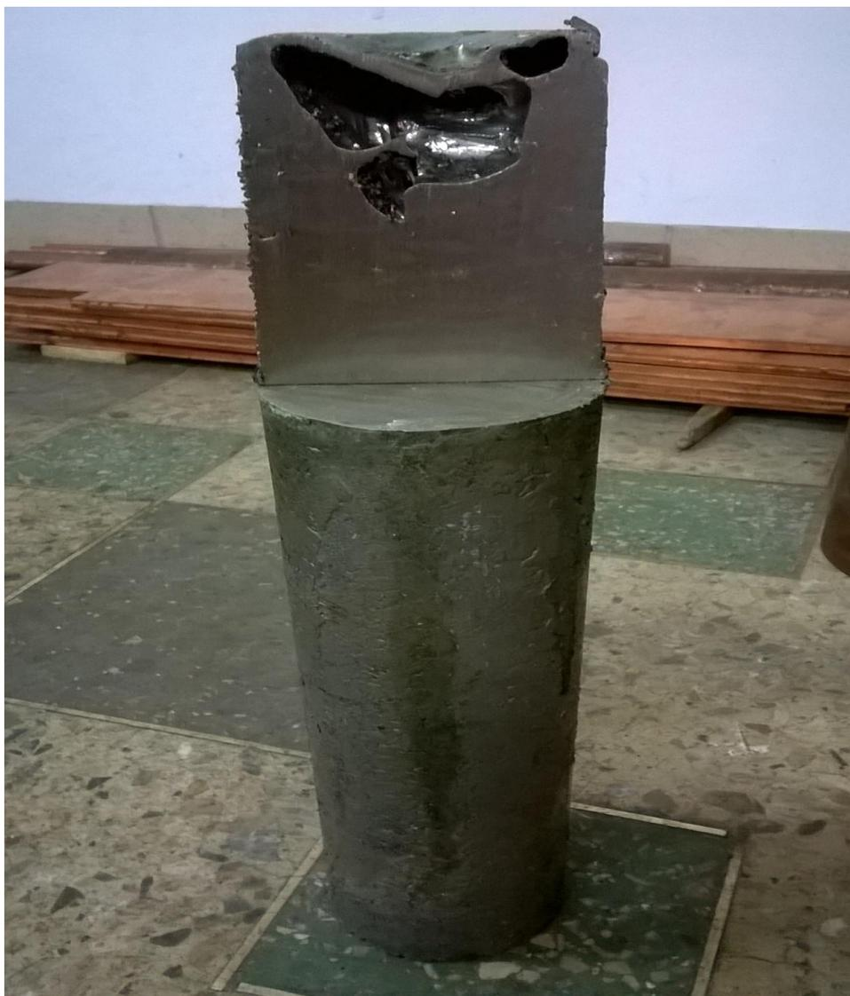
Рисунок 1 - Слиток с прибылью в разрезе
