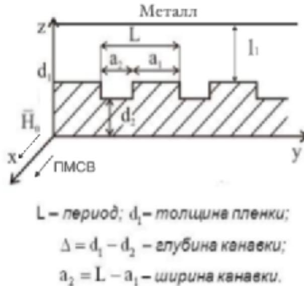
Рис. 1. Металлизированный магнотонный кристалл.
