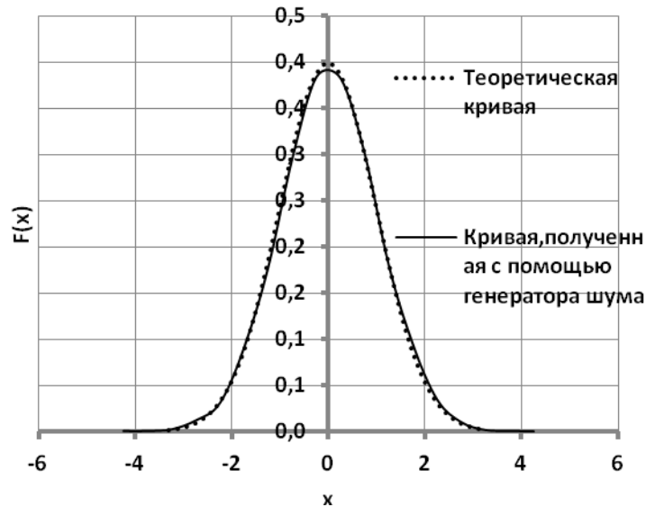
Рис. 15: Сравнение теоретического распределения и распределения, полученного с помощью генератора шума
