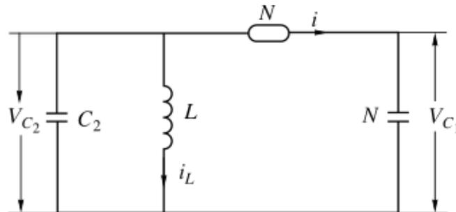
Рисунок 6. Принципиальная схема генератора TORUS
