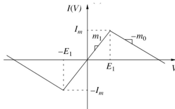
Рисунок 7. Вольт амперная характеристика нелинейного элемента
