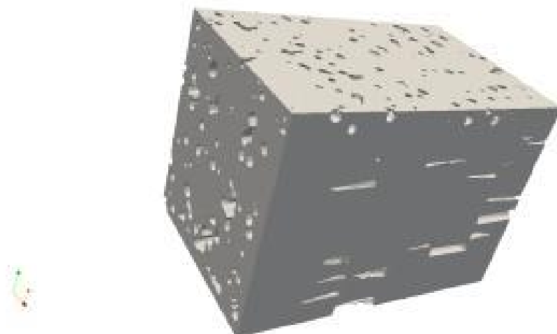
Рисунок 6 — Модельный образец после удаления элементов STL-поверхности, последняя итерация
