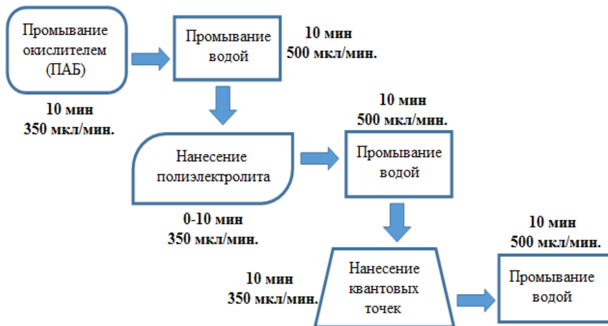
Рис.1. Схема нанесения квантовых точек на мультикапилляр.
