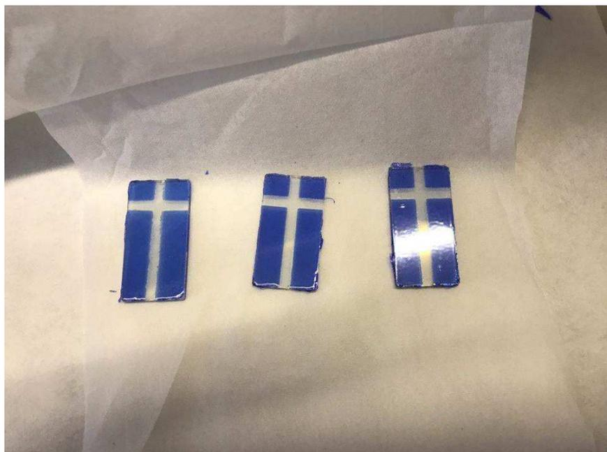
Рисунок 1 - Стекло с нанесенным фоторезистом
