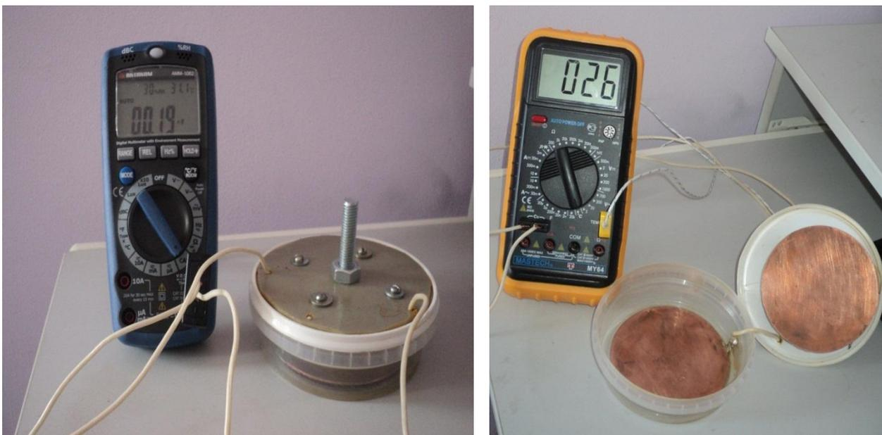
Рис. 5 Установка для измерения емкости различных жидкостей
