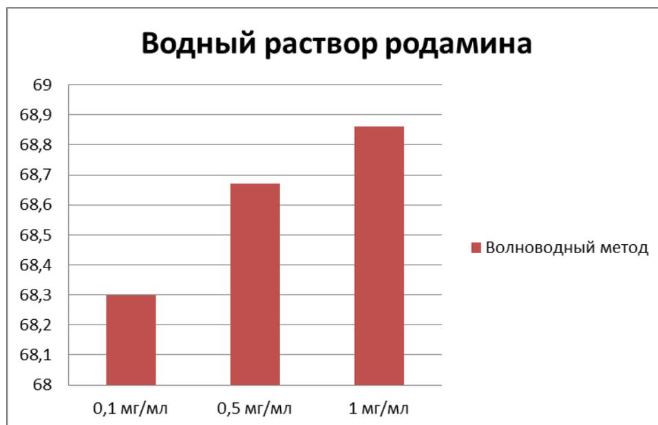
Рис. 4 Диаграмма зависимости диэлектрической проницаемости водного раствора родамина от концентрации.
