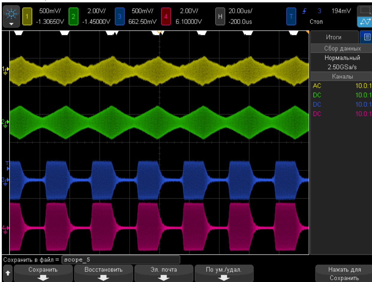
Рисунок 4 Осциллограммы напряжений при включении в цепь опорного генератора на выходах (X, dX/dt ), (Y, dY/dt ), по оси абсцисс напряжение в В, по оси ординат время в с
