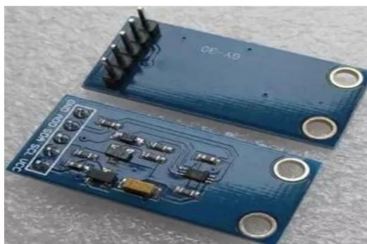
Рис.1 Датчик освещенности
