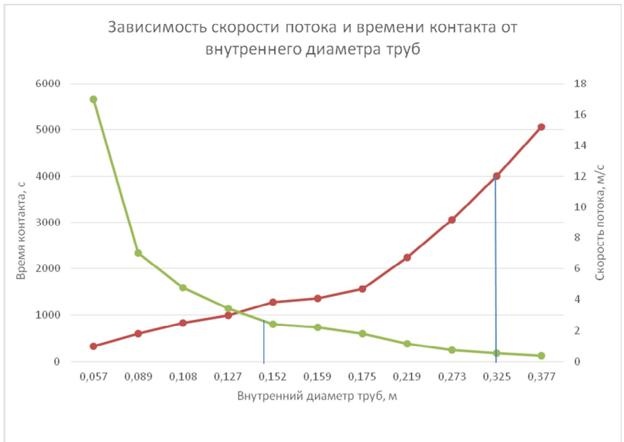
Рисунок 1 – зависимость скорости потока и времени контакта от диаметра трубы
