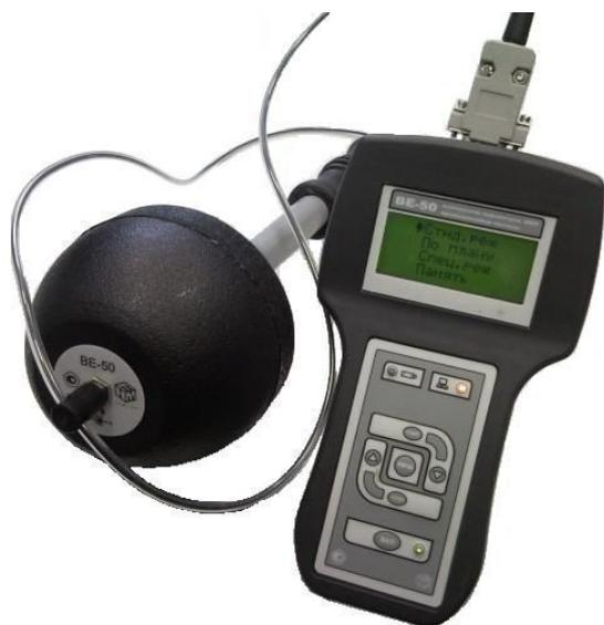
Рисунок 1 – Измеритель электромагнитного поля промышленной частоты «ВЕ-50».
