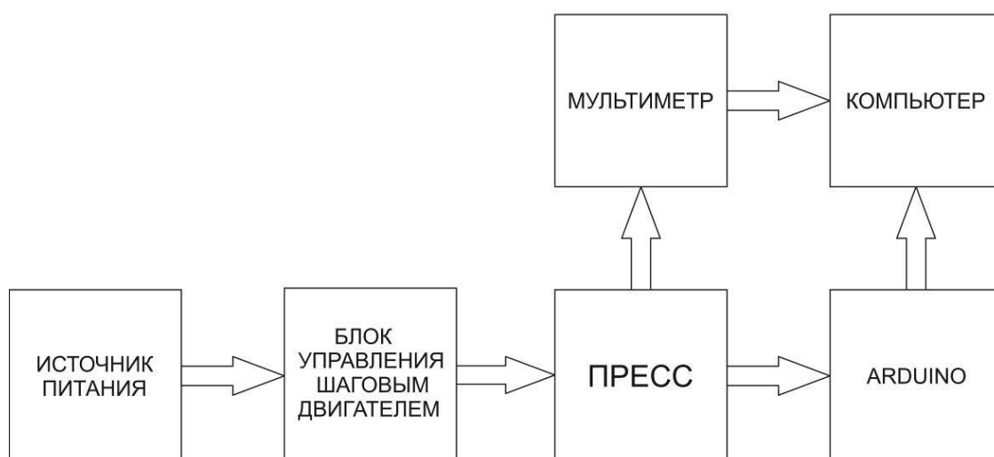
Рисунок 4 – блок-схема измерительной установки
