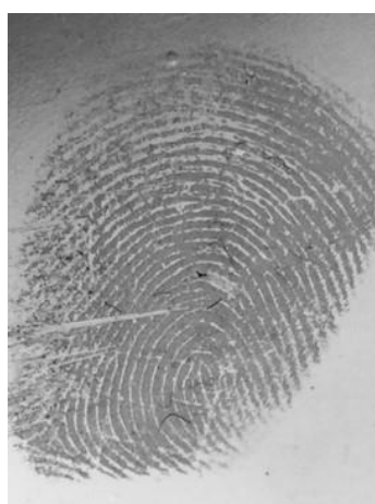
Рисунок 7 – След пальца руки на прозрачном пластике, выявленный методом магнетронного напыления меди
