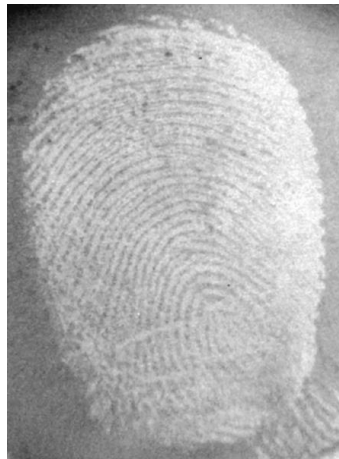
Рисунок 4 – След пальца руки на белой глянцевой бумаге, выявленный методом магнетронного напыления золота
