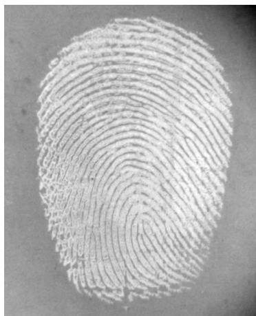
Рисунок 1 – След пальца руки на белой глянцевой бумаге, выявленный методом термовакуумного напыления углерода
