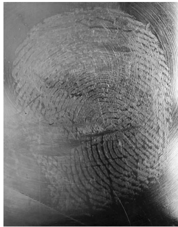
Рисунок 3 – След пальца руки на латуни, выявленный методом магнетронного напыления золота
