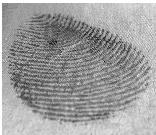
Рисунок 2 – След пальца руки на зеленой глянцевой бумаге, выявленный методом термовакуумного напыления углерода
