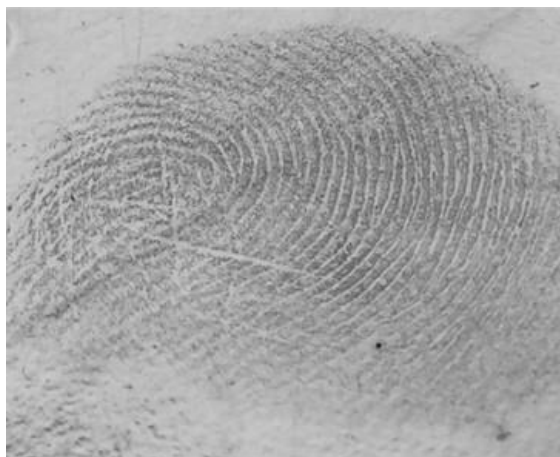
Рисунок 5 – След пальца руки на белом пластике, выявленный методом магнетронного напыления меди
