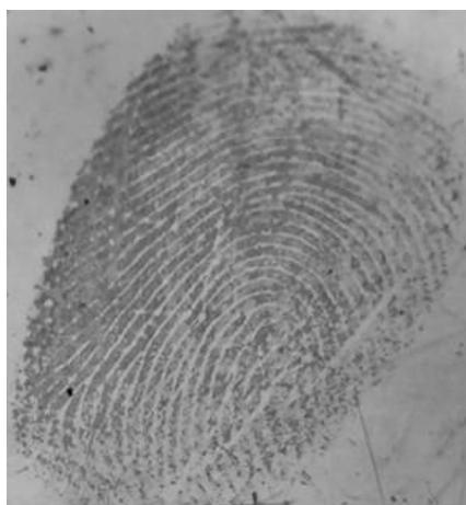
Рисунок 6 – След пальца руки на органическом стекле, выявленный методом магнетронного напыления меди
