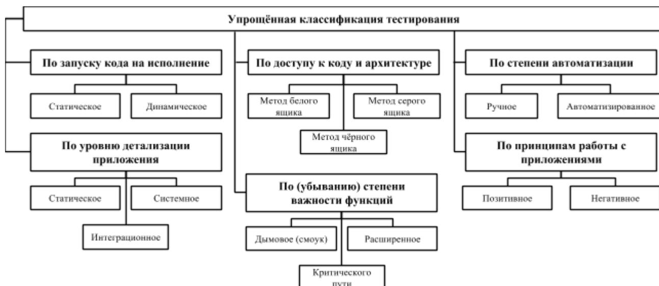
Рисунок 8 – Упрощённая классификация тестирования
