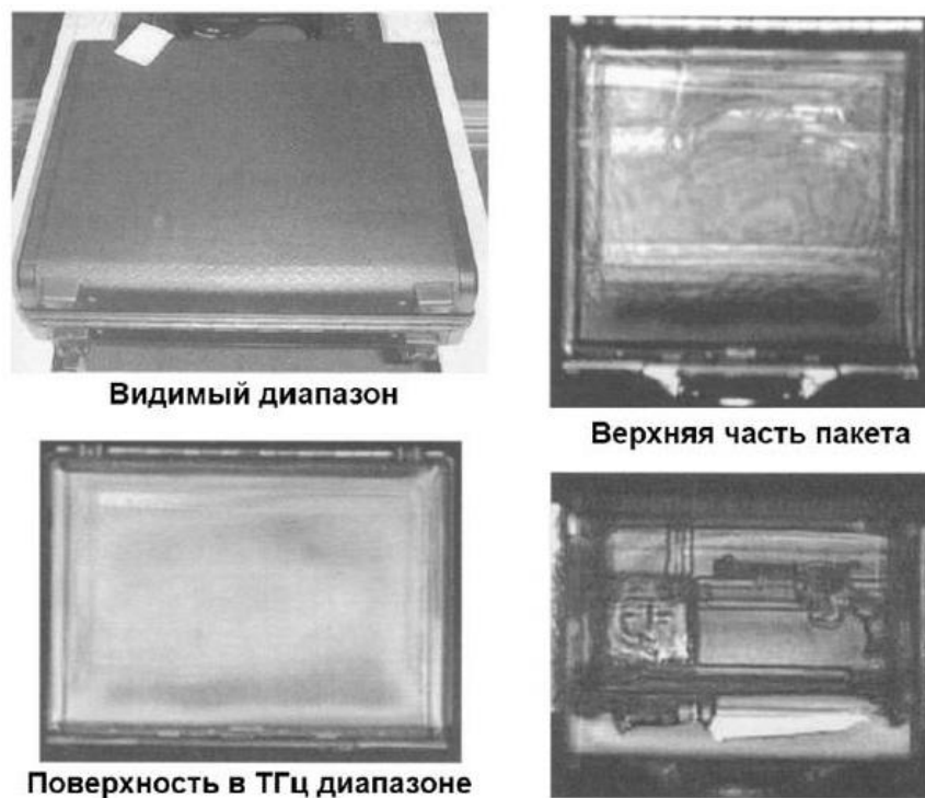
Рисунок 2. Пример работы импульсной активной системы радиовидения, работающей с отраженным от объекта излучением.
