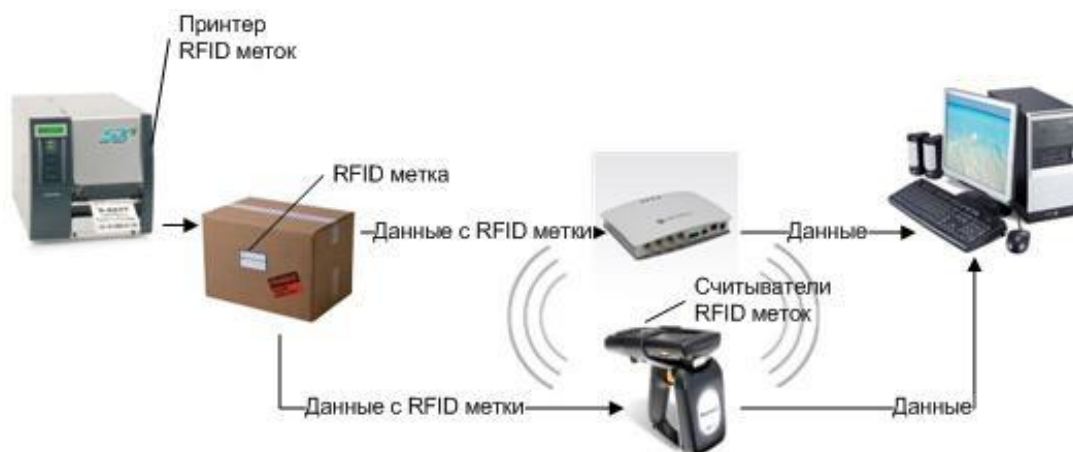
Рисунок 1. Схема работы RFID-системы
