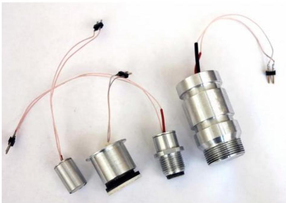
Рисунок 1. Ультразвуковые излучатели/приемники. Область применения – различные виды оборудования, где используется явление отражения ультразвуковых колебаний от плоскости раздела сред жидкость-газ. Эти датчики применяются в уровнемерах, сигнализаторах, расходомерах.
