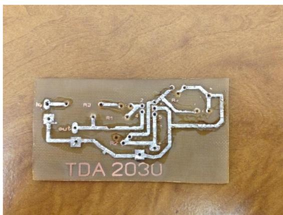
Рис. 4. Вид печатной платы схема RC-интегратора после лужения дорожек.
