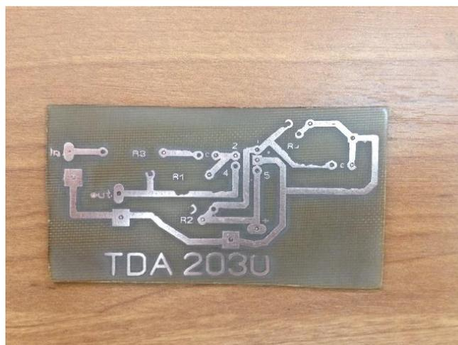
Рис. 3. Результат нанесения изображения принципиальной схемы интегратора после травления платы.
