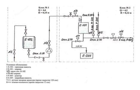
Блок №1. Узел приема и расхода НАК на отм. 0.00
