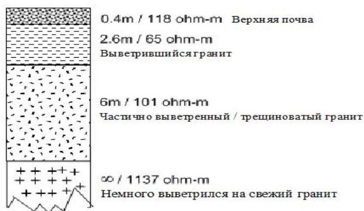
Рисунок 2 – Интерпретация полевой кривой ВЭЗ в пункте 1.
