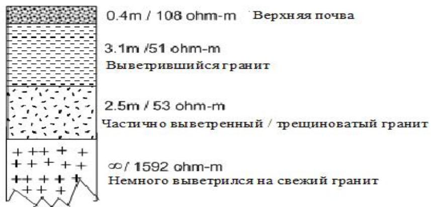
Рисунок 5 – Интерпретация полевой кривой ВЭЗ в пункте 4.
