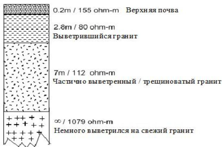
Рисунок 6 – Интерпретация полевой кривой ВЭЗ в пункте 5.
