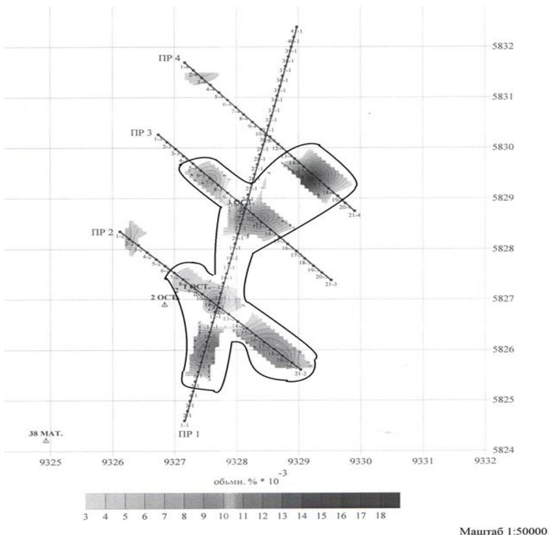
Рисунок – 2 Концентрации  $\text{CH}_4$ (метан) абсорбированного в почвенном покрове Остролукского участка (по данным [11]).
