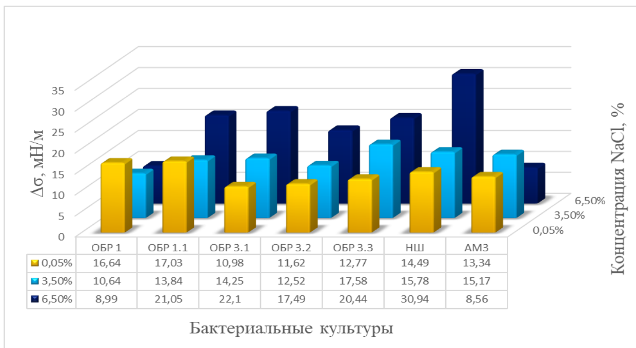
Рисунок 2 – Снижение поверхностного натяжения в супернатантах при выращивании бактерий в присутствии NaCl (0,05; 3,5 и 6,5%).
