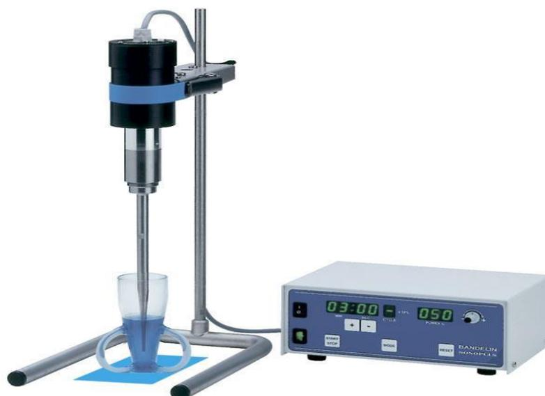
Рисунок 1 – Ультразвуковой гомогенизатор Bandelin Sonopuls HD 2070
