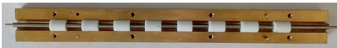
Рисунок 1.13 Пятнадцатислойный коаксиальный фотонный кристалл без нарушения вид сверху
