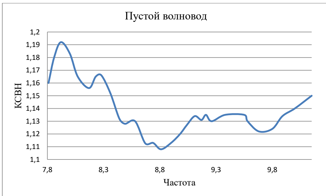
Рисунок 11 – График зависимости КСВН от частоты в пустом волноводе.
