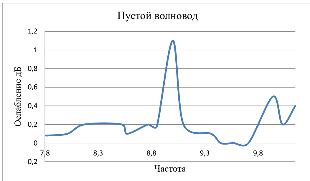
Рисунок 11 – График зависимости ослабления от частоты в пустом волноводе.
