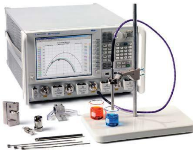
Рисунок 10 – Измерительная установка методом коаксиального пробника.
