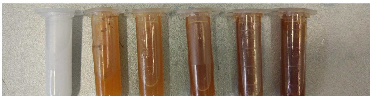
Рисунок 7 – Композитные частицы в растворе гептана. а – чистый \text{CaCO}_3 , б – 1 слой \text{Fe}_3\text{O}_4 , в – 2 слоя, г – 4 слоя, д – 6 слоёв, е – 8 слоёв.
