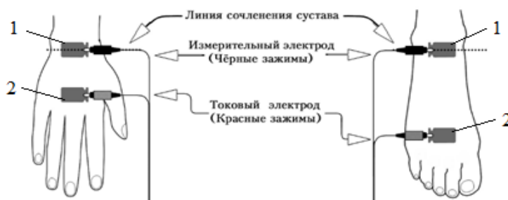
Рисунок 2 – Схема крепления электродов к руке и ноге исследуемого
