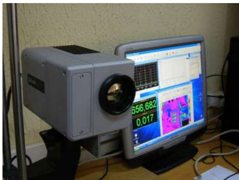
Рис.1 Установка тепловизора ThermaCAM SC3000 фирмы FLIR Systems с программным обеспечением.
