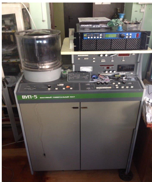
Рисунок 1 – Фотография модернизированной установки магнетронного распыления вакуумного универсального поста (ВУП-5)
