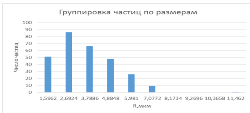
Рисунок 2 – Гистограмма группировки частиц порошка по размерам.
