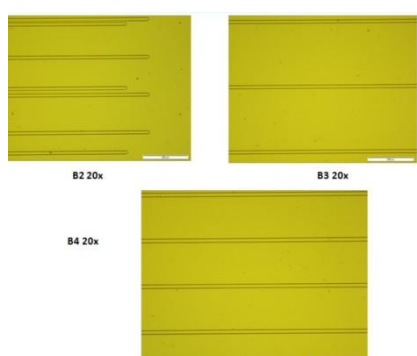
Рисунок 4 – Снимки с оптического микроскопа МХ 51 всех участков образца В после процедур очистки от фоторезиста и пермаллоя
