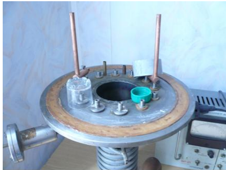
Рисунок 4 – Подколпачное пространство рабочей камеры с подготовленными к выявлению следов рук объектами
