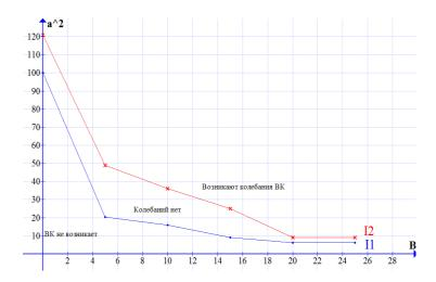
Определены границы применения модели и исследовано поведение электронного пучка при больших магнитных полях порядка 0,6Тс. Получены картины пульсации и разрушения виртуального катода. Сделан вывод, что виртуальный катод не образуется в сильном магнитном поле, поскольку электронам не хватает энергии совершить переходный процесс.
