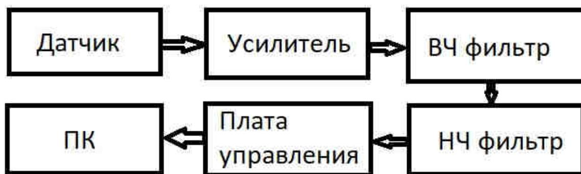
**Рисунок 21.** Структурная схема построения многоканального фотоплетизмографа.
