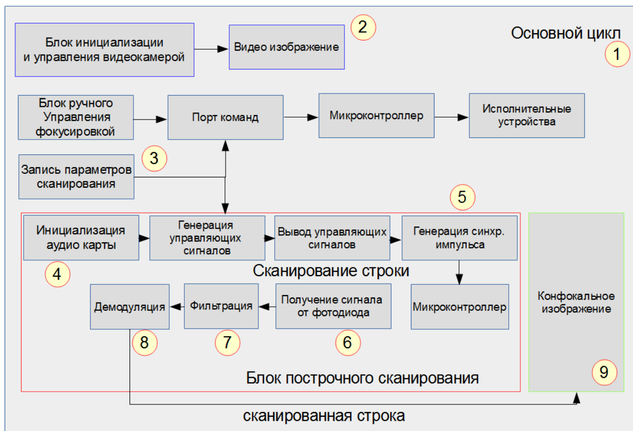
Рисунок 2 - Блок схема программной части ЛСКМ
