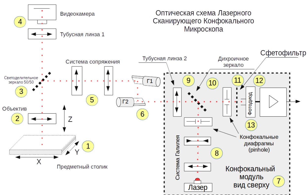
Рисунок 1 - Оптическая схема ЛСКМ
