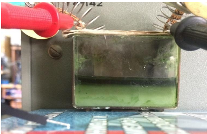
Рисунок 2. Замер сопротивления при облучении раствора хлорофиллипта СВЧ- излучением частотой 45 ГГц
