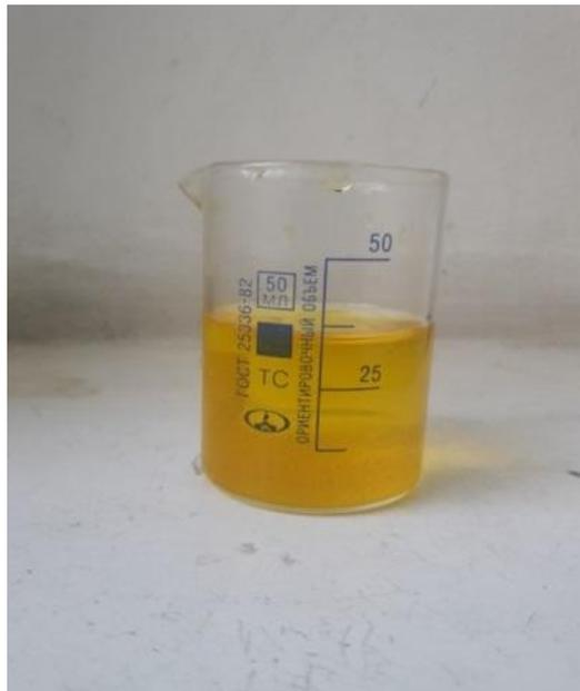
Рисунок 1. Раствор желатина и  $K_2Cr_2O_7$  в растворе  $AgCl$  и дистиллированной воды.
