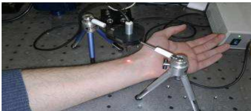
Рисунок 20 – Регистрация пульсовой волны лазерным автодином
