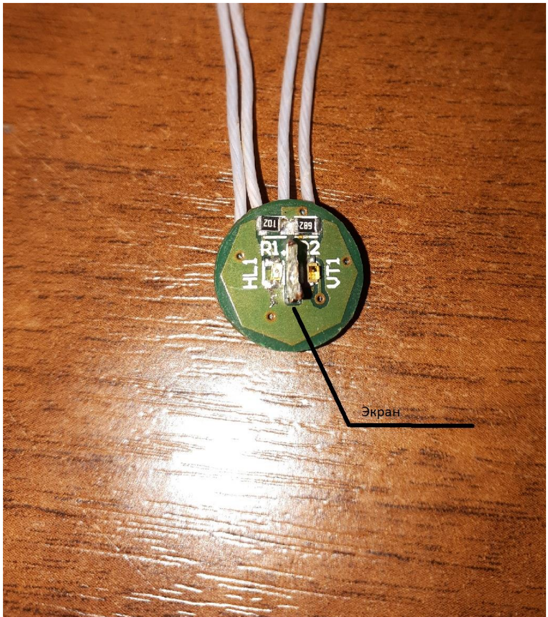
Рисунок 2 Экранирование излучателя от фотоприемника
