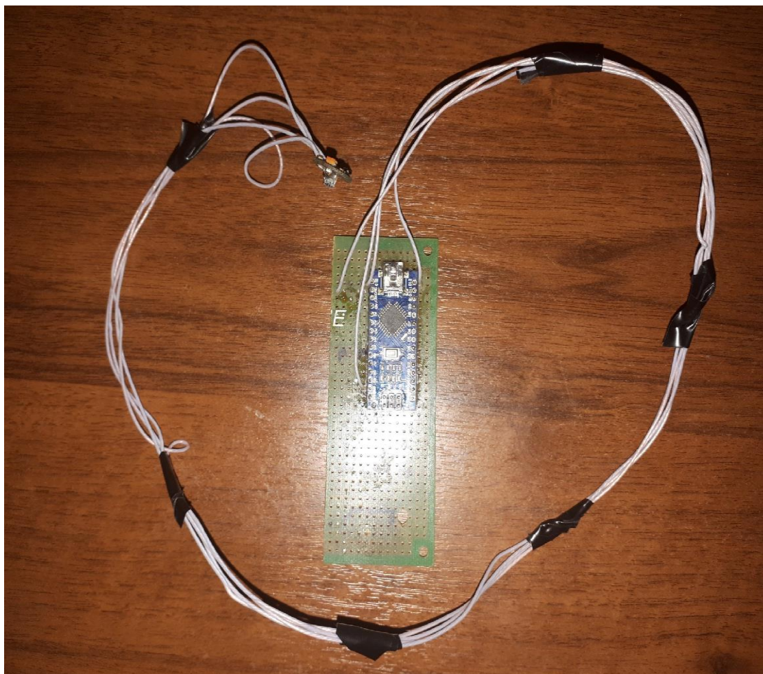
Рисунок 3 Соединение датчика ФПГ с Arduino Nano
