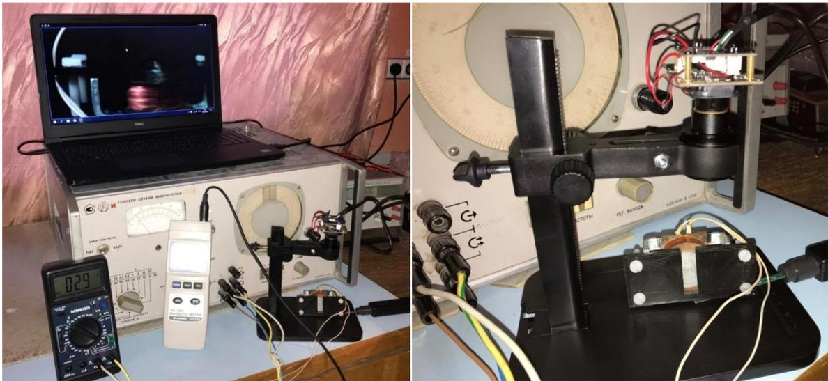
Рисунок 5 – Фотографии установки предназначенной для исследования магнитных свойств полученных структур с помощью переменного магнитного поля
