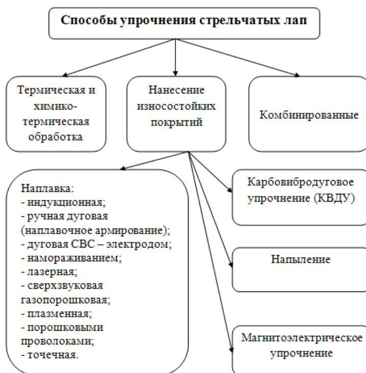
Рисунок 2 – Способы упрочнения стрельчатых лап почвообрабатывающих орудий
