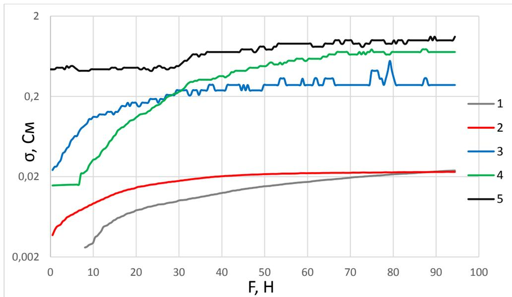
Рисунок 5 – Зависимость проводимости  $\sigma$  от приложенной нагрузки  $F$  при сжатии для пяти образцов
