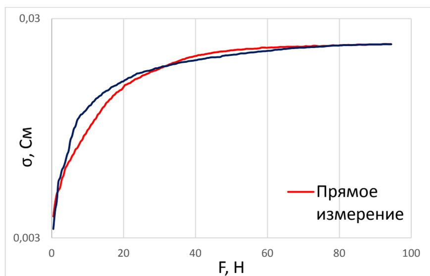
Рисунок 6 – Зависимость проводимости  $\sigma$  образца 2 от приложенной нагрузки  $F$  при сжатии и возвращении в первоначальное положение пружины
