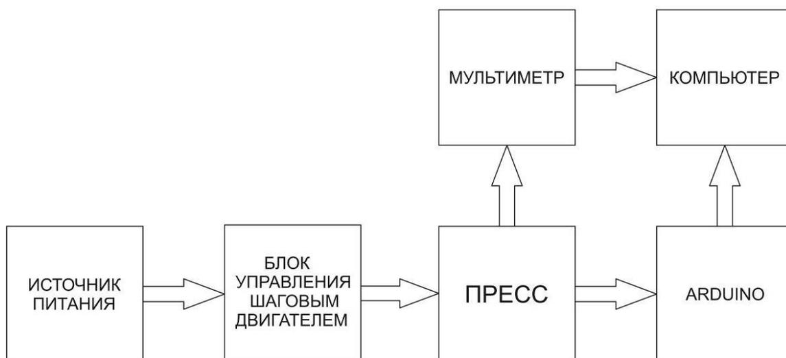
Рисунок 4 – блок-схема измерительной установки
