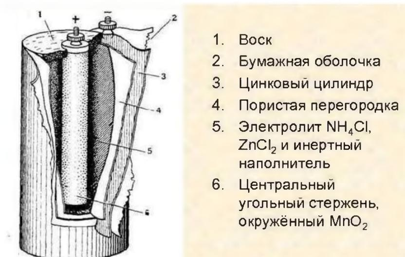
Рисунок 1 – Устройство гальванического элемента Лекланше
